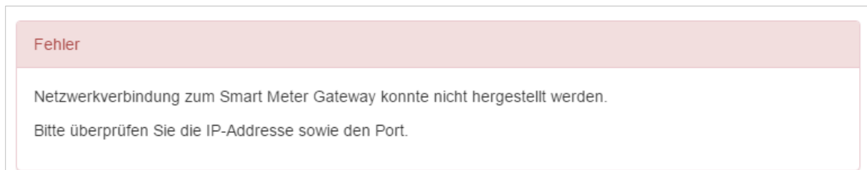
Abbildung 20 - Ein möglicher Fehler beim Anmelden am SMGW
